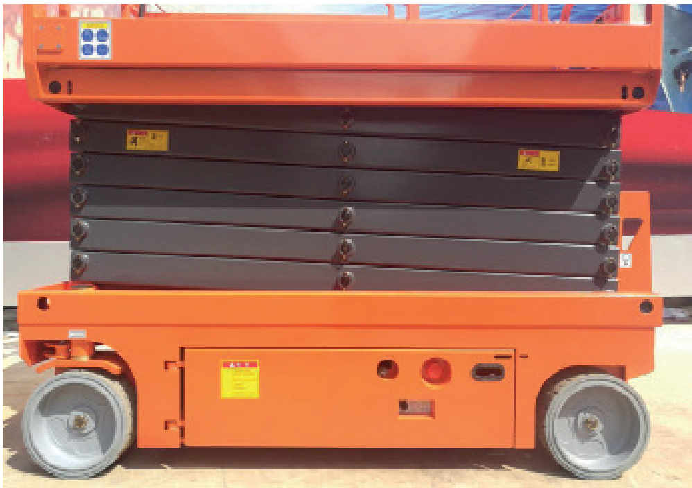
1. Sjekk om firkanttrøret er ødelagt
