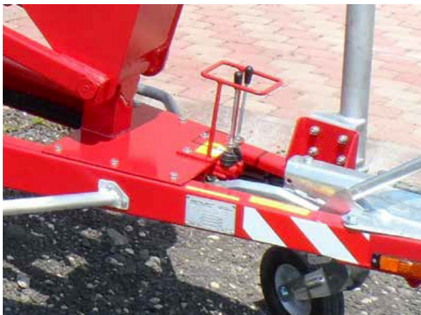
Venstre og høyre spak for friksjons-driften
